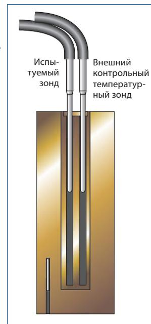
Максимальную точность для коротких зондов можно получить путем сравнения с показаниями аналогичного зонда на такой же глубине камеры.
